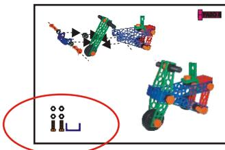
LAS PIEZAS SE UNEN ENTRE SI MEDIANTE TORNILLOS Y TUERCAS. PARA SABER POR DONDE DEBEN PASAR LOS TORNILLOS, TE PUEDES GUIAR POR LAS LINEAS PUNTEADAS QUE FIGURAN EN CADA UNO DE LOS PASOS.
