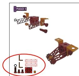
LAS PIEZAS SE UNEN ENTRE SI MEDIANTE TORNILLOS Y TUERCAS. PARA SABER POR DONDE DEBEN PASAR LOS TORNILLOS, TE PUEDES GUIAR POR LAS LINEAS PUNTEADAS QUE FIGURAN EN CADA UNO DE LOS PASOS.
